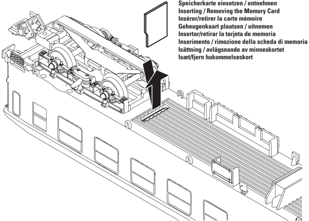
Speicherplatte einsetzen / entnehmen
