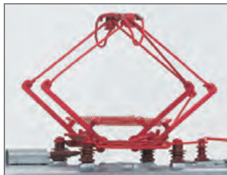
Met op- en neer beweegbare, nieuw ontworpen pantografen type DBS 54
