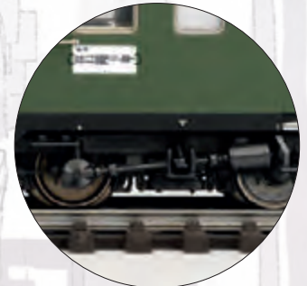
Voorbeeldgetrouw voorzien van draaistellen type Minden-Deutz (MD) zwaar type 330 met dynamo op een cardanas type D 150
