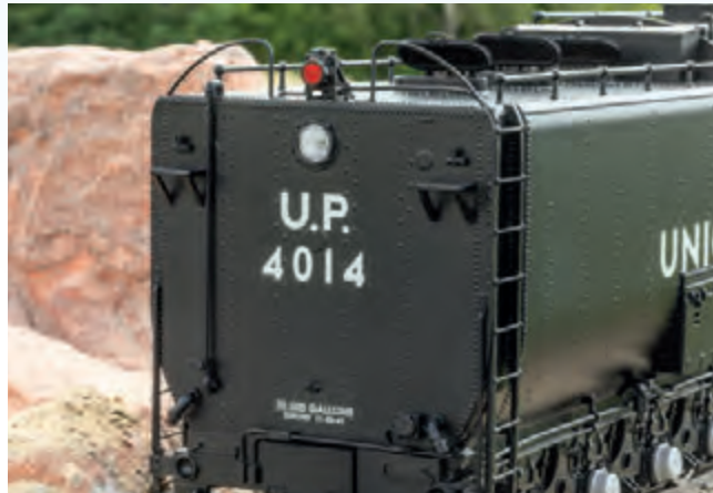
Het rode sluitlicht kan in- en uitgeschakeld worden
