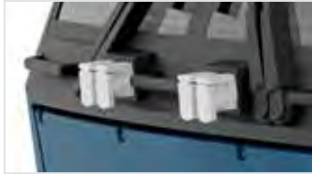
Filigrane extra angesetzte Griffstangen, UIC-Dosen und Scheibenwischer
