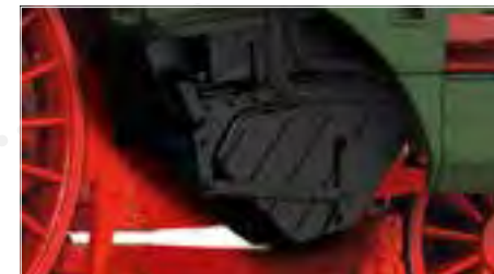
Vorbildgerechte Ausführung des Aschkasten
