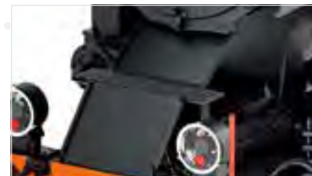
Schütte unter der Rauchkammertüre
