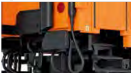
Pufferbohle vollständig zurüstbar
