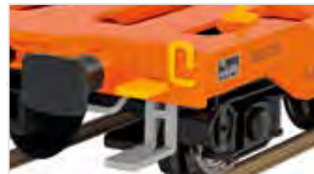
Nachbildung von Griffstangen und Trittstufen
