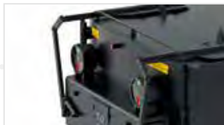
Wasserkasten-Hebel freistehend und separat ausgeführt
