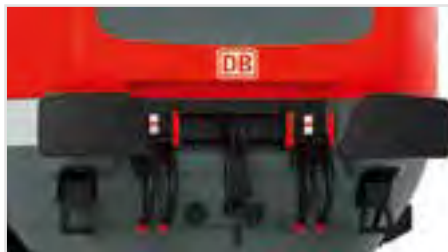
Aufwendig zugestützte Pufferbohle
