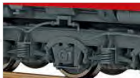
Vollständige Nachbildung der Bremsluftleitungen
