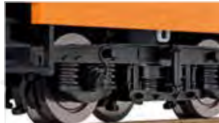
Vorbildgerechte Drehgestelle der Bauart Görlitz V modifiziert
