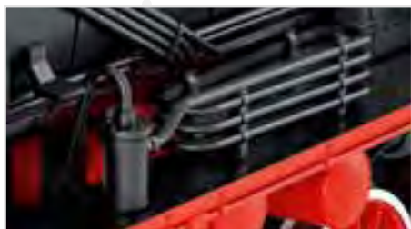
Aufwendig nachgebildeter Lufttrockner mit Ölabscheider
