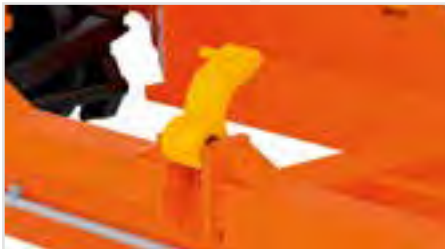
Klappriegel beweglich für Transport von Containern
