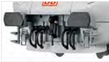
Detaillierte Nachbildung der Pufferbohle
