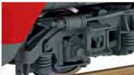
Bremszylinder detailliert ausgeführt
