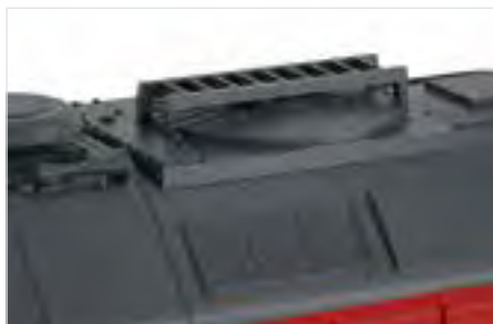
Dachausführung mit Leiter
