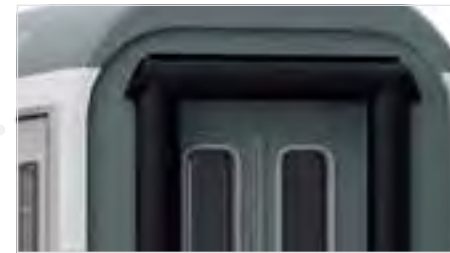
Betriebszustand mit Gummiwulst-Übergang
