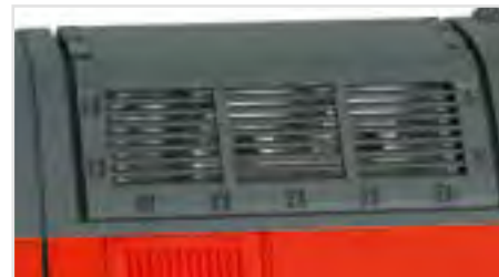
Durchbrochen dargestellte Lüftergitter mit dahinterliegender Klimaanlage und Kompressor
