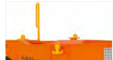
Separat angesetzte Seilankerhaken
